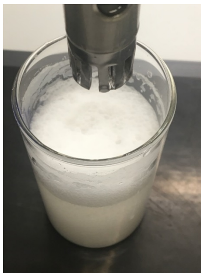
Рисунок 5 – Внешний вид флуралита после перемешивания турбосмесителем
