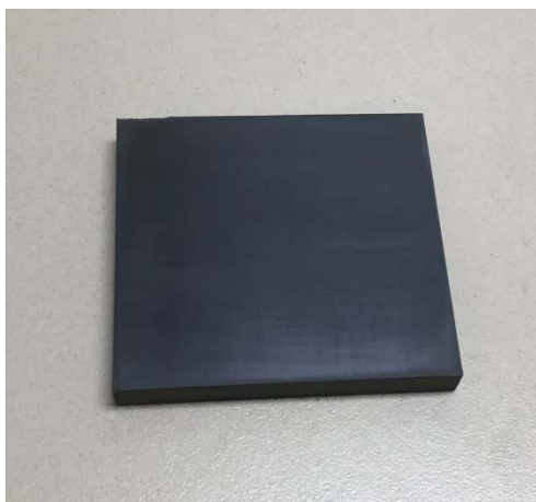
Рисунок 10 – Полученная заготовка, из которой будут вырезаться образцы для испытаний
