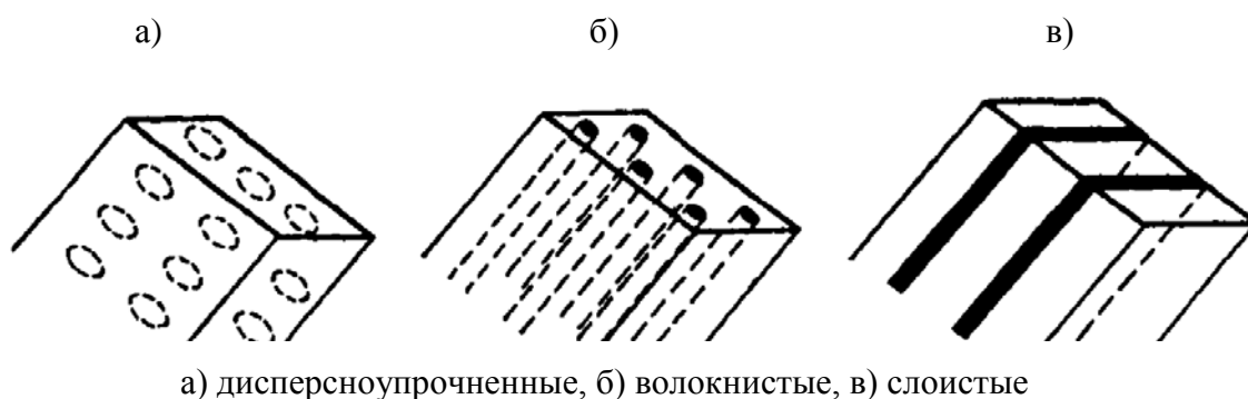
Рисунок 3 – Схема строения композиционных материалов
