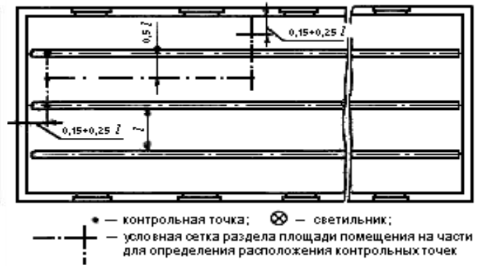
Рис.5 Расположение контрольных точек при измерении минимальной освещенности помещения от светильников, принимаемых за линейные излучатели
