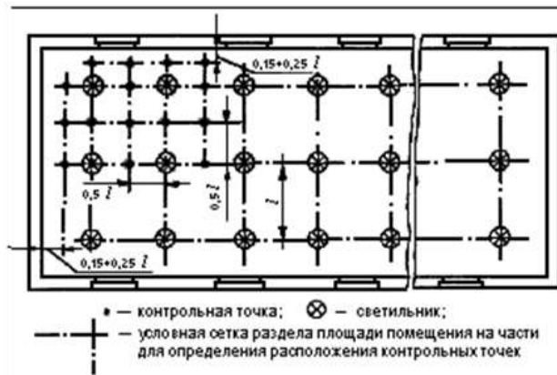
Рис.4. Расположение контрольных точек при измерении минимальной освещенности помещения от светильников, принимаемых за точечные излучатели
