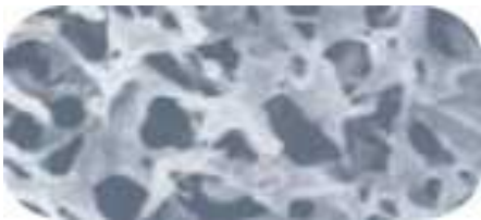
Микрофльтрационные гидрофобные и гидрофильные фторопластовые мембраны марки МФФК и МФФК.Г
