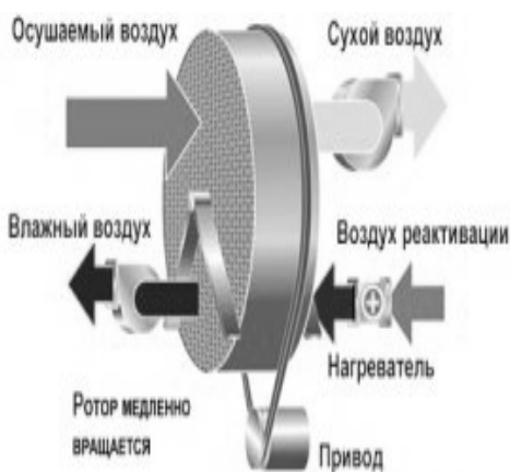
Рис. 3.19. Адсорбционный Ротор-осушитель Мунтера
