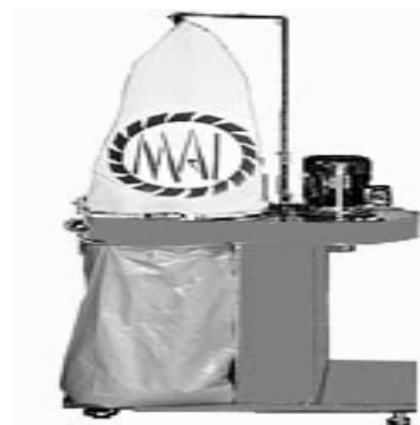
Рис.3.30. Пылеотсос одноместный для удаления стружки, опилок и древесной пыли от д/о станков и их фильтрации
