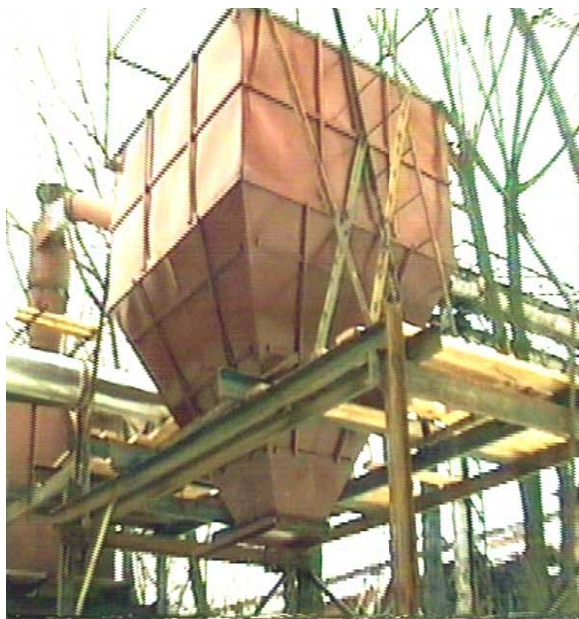
Рис. 7.7. Бункер из тонкого железа с ребрами жесткости (прожилинами)
