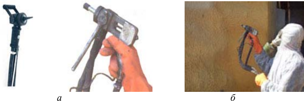
Рис. 5.38. Напыление полиуретана: а – пистолет для напыления; б – процесс напыления
