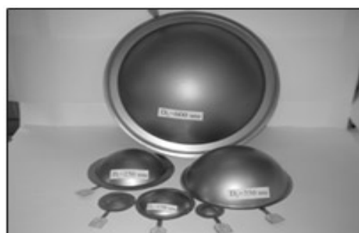
Рис. 3.77. Мембраны, разрушающиеся вдоль линии ослабляющих насечек
