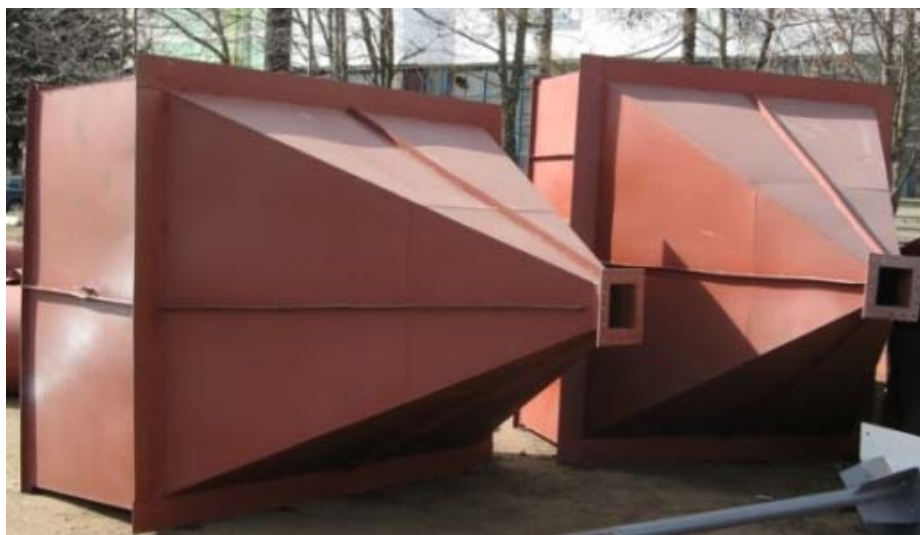
Рис. 3.88. Вид пирамидального бункера ПГУ перед монтажом ( www.energomash-tver.ru )
