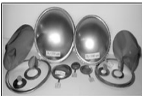
Рис. 3.76. Мембраны с периферийным (радиальным) локальным ослаблением в виде насечек
