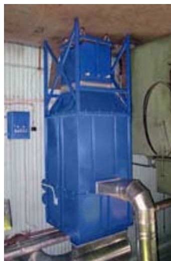
Рис. 3.94. Пылесборник в виде выдвигного ящика ( www.energomash-tver.ru )
