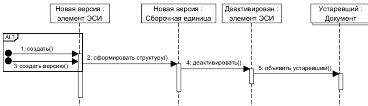
Рис. 3.3. UML-диаграмма последовательностей, которая показывает деактивацию объектов проектирования типа «Документ» и «элемент ЭСИ»
