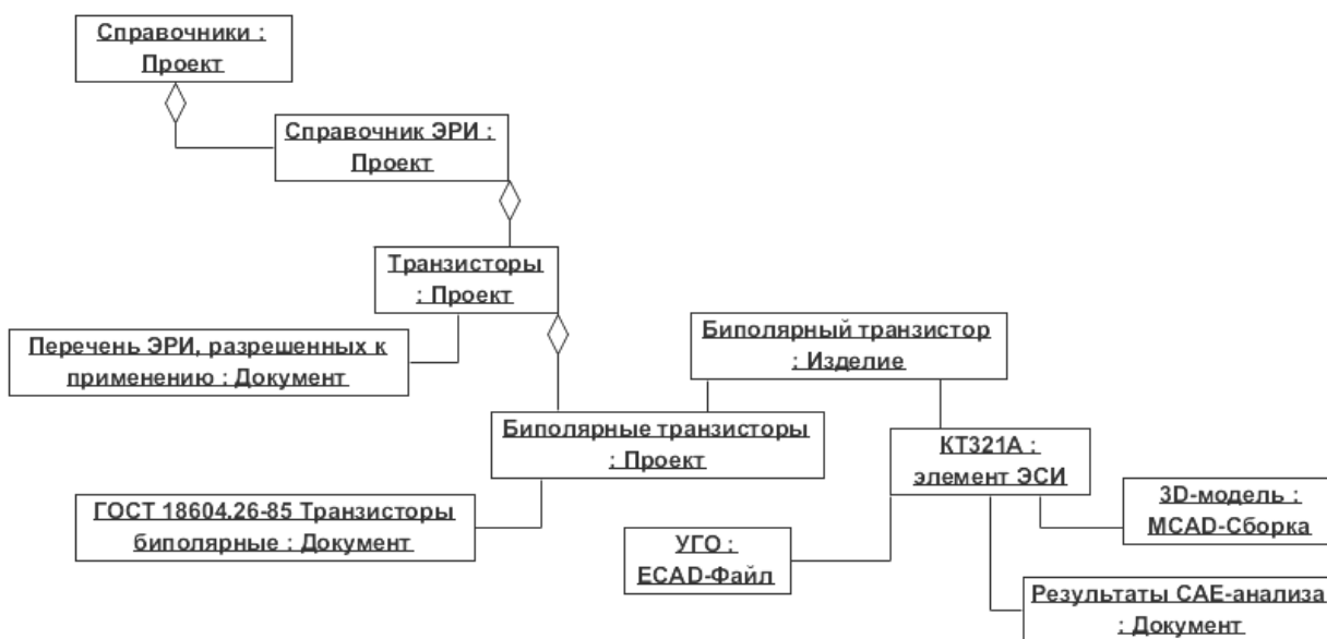
Рис. 3.20 – UML-диаграммы объектов, которая иллюстрирует предложенную структуру хранения справочных данных (типовых объектов) в СУД
