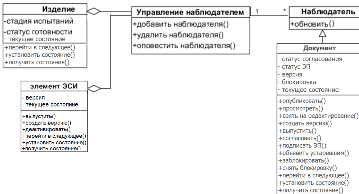
Рис.3.19. Взаимосвязи классов «Изделие», «элемент ЭСИ» и «Документ» в виде UML-диаграммы классов шаблона проектирования «Наблюдатель»
