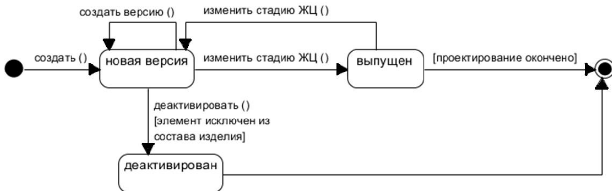
Рис. 3.2. UML-диаграмма состояний объекта класса «элемент ЭСИ»
