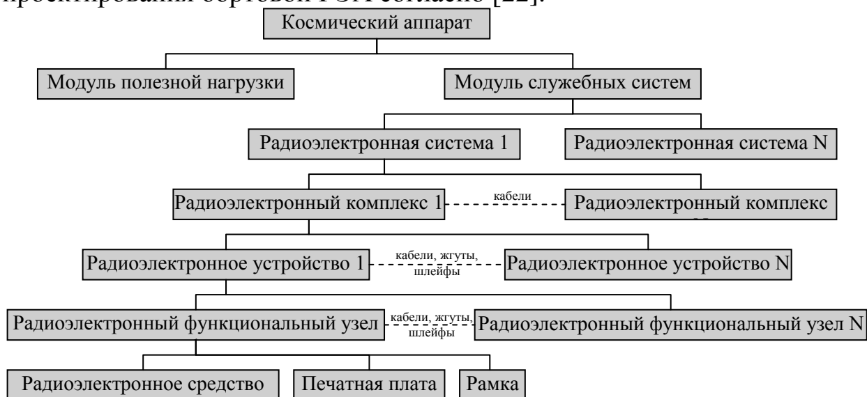
Рис. 1.1. Основные компоненты КА с точки зрения проектирования РЭА
