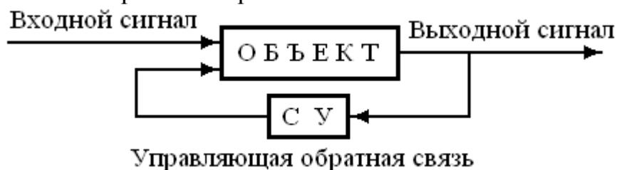
Рис. 1-1. Система управления с обратной связью
