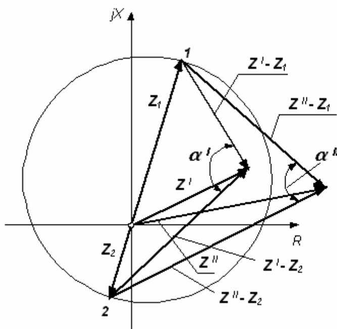
**Рис.60** Принцип работы реле сопротивления
