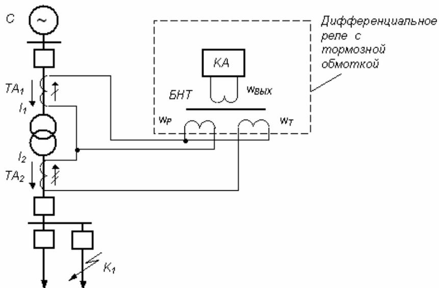
**Рис.74** Принцип действия защиты с торможением:
