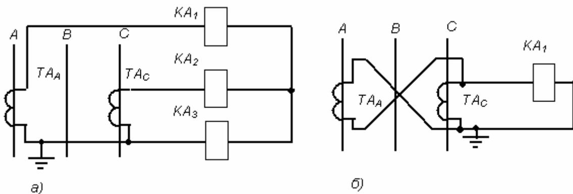
**Рис.35** Схемы соединения трансформаторов тока и реле: а) в неполную звезду; б) на разность токов двух фаз
