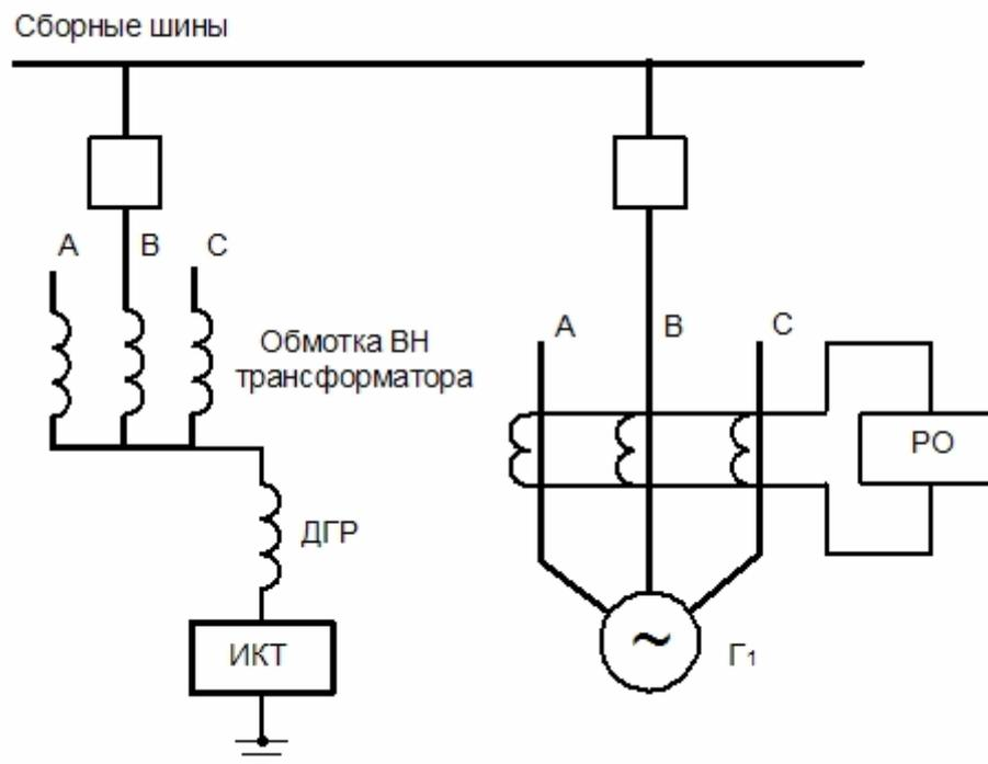
**Рис.93** Схема включения защиты на наложенном переменном токе
