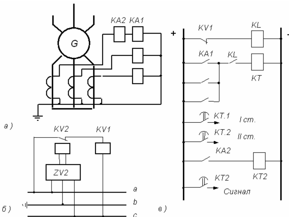
**Рис.95** Схема максимальной токовой защиты с блокировкой по напряжению:
