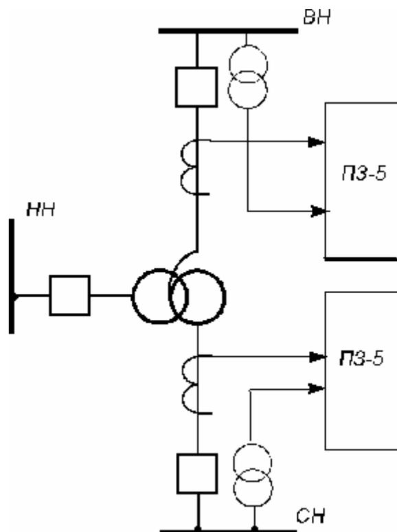
Рис.87. Схема подключения двух панелей ПЭ-2105.
