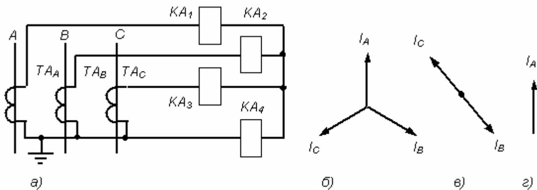
**Рис.34** Соединение трансформаторов тока и реле по схеме полной звезды: а) схема полной звезды; б) векторная диаграмма токов при трехфазном замыкании; в) векторная диаграмма токов при замыкании фаз **B** и **C**; г) векторная диаграмма токов при замыкании фазы **A** на землю.
