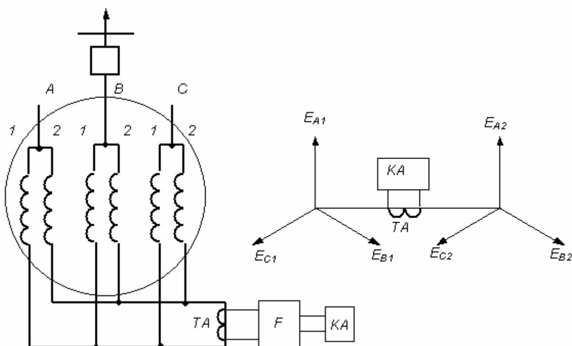
**Рис.90** Принцип действия поперечной дифференциальной защиты генератора
