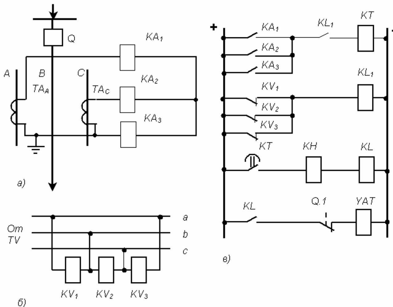
**Рис.40** Схема максимальной токовой защиты с блокировкой по напряжению:
