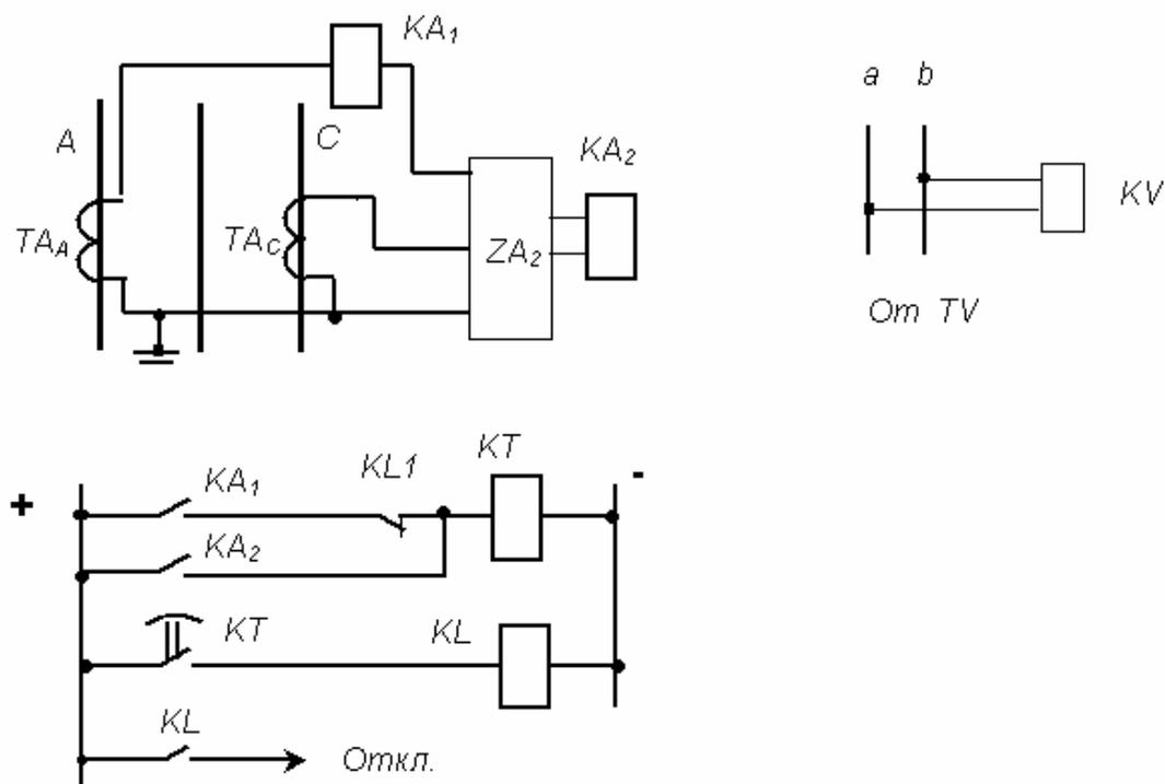
Рис.85 Токовая защита обратной последовательности
