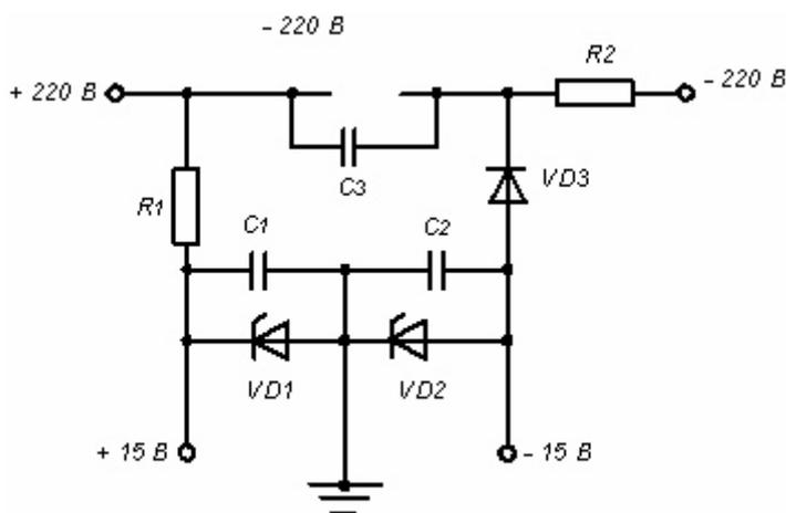
Рис.31 Схема питания реле от сети постоянного оперативного тока 220 В
