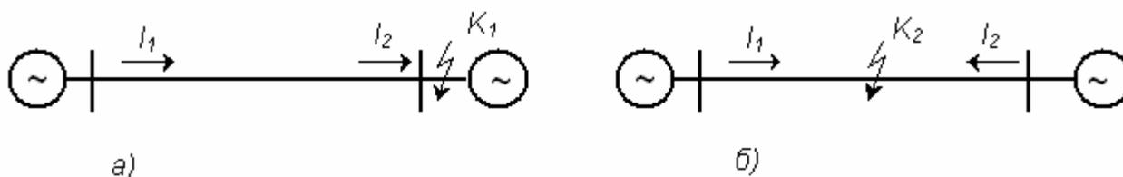
**Рис.70** Принцип действия дифференциально-фазной высокочастотной защиты:
