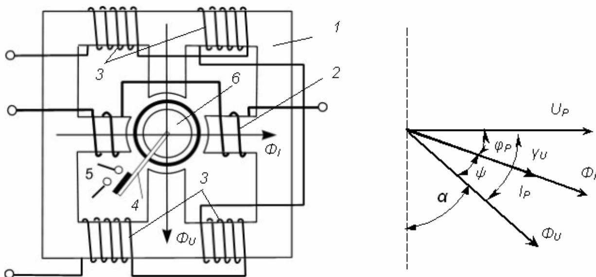
Рис. 47 Индукционное реле мощности    Рис. 48 Векторная диаграмма реле
