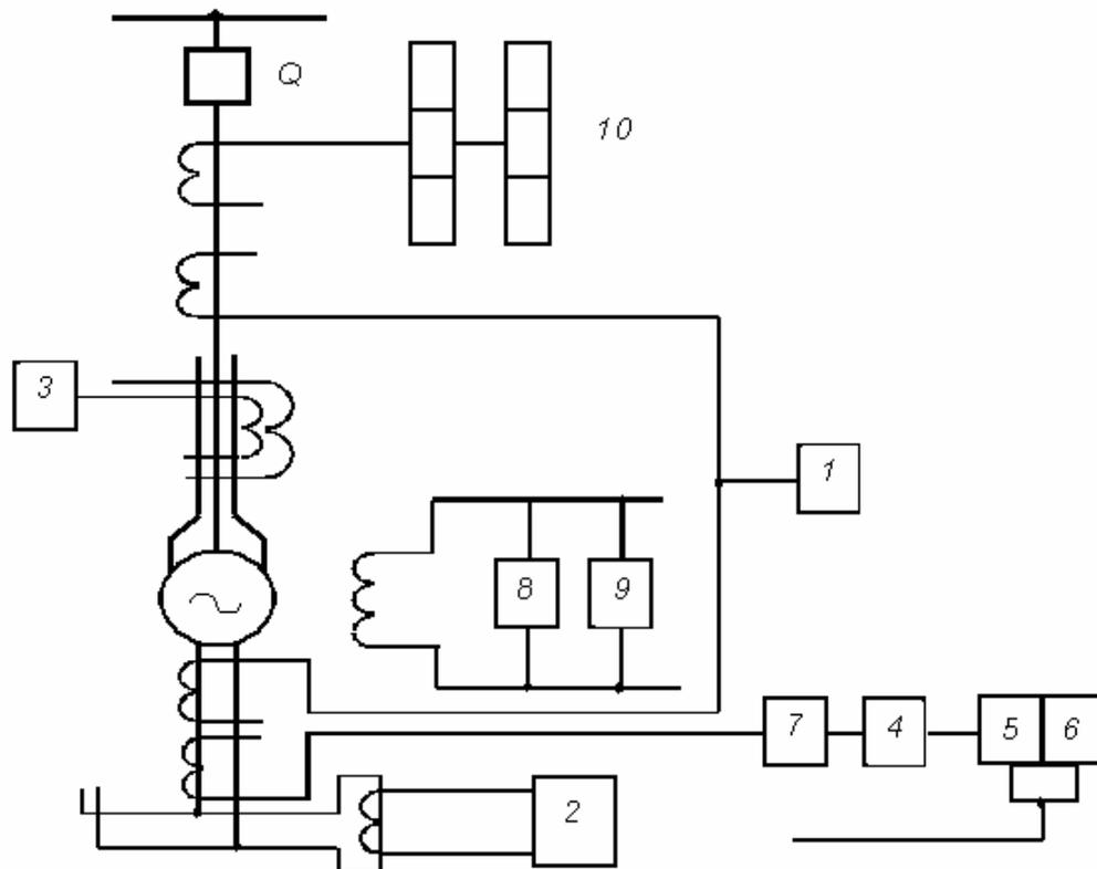
**Рис.99** Принципиальная схема релейной защиты турбогенератора:
