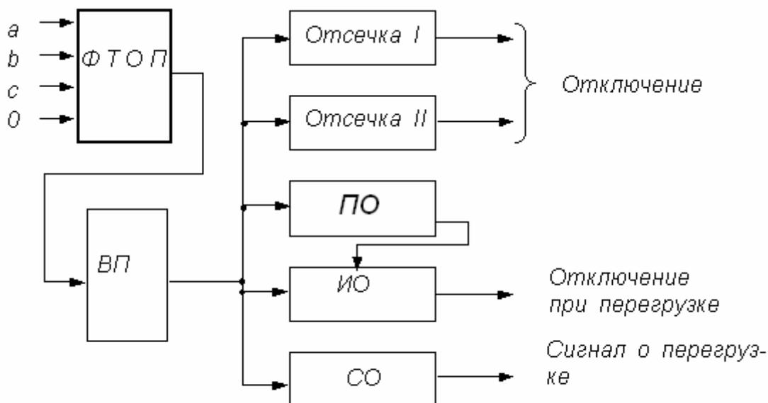
**Рис. 97** Структурная схема четырехступенчатой токовой защиты обратной последовательности
