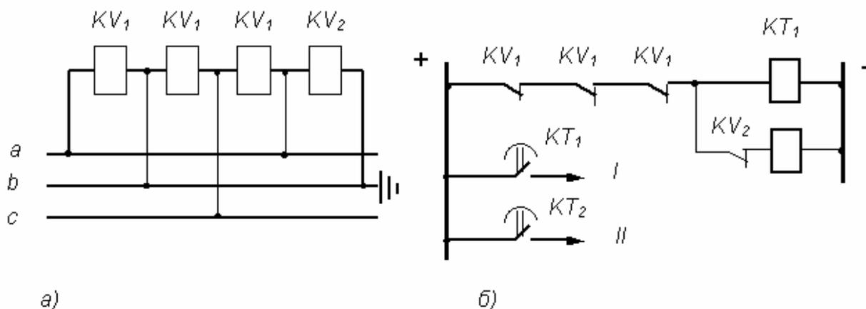
**Рис.101** Схема защиты минимального напряжения:
