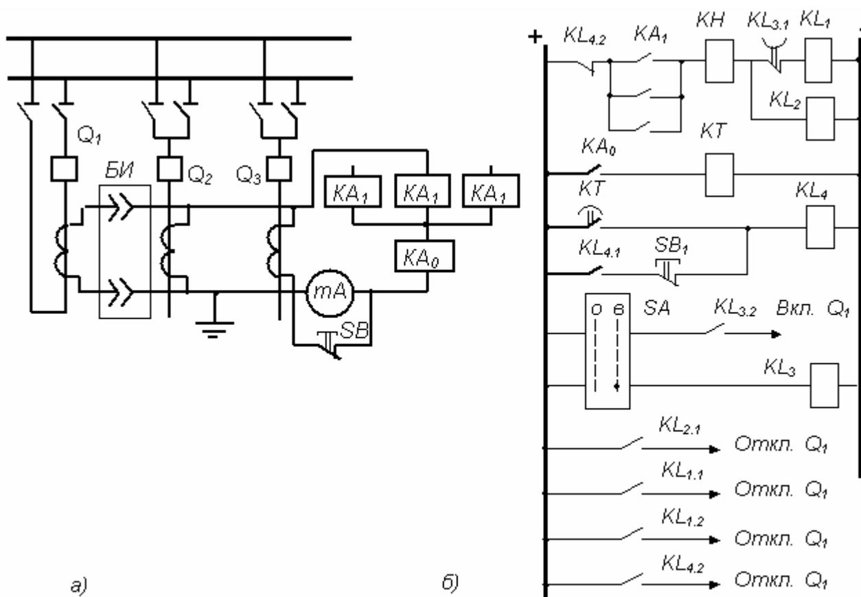
**Рис.105** Схема дифференциальной защиты шин с одной рабочей и одной резервной системами шин:
