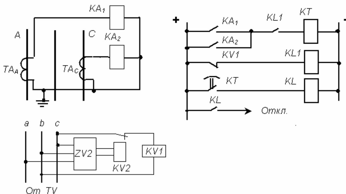
Рис.84 Схема максимальной токовой защиты с блокировкой по напряжению
