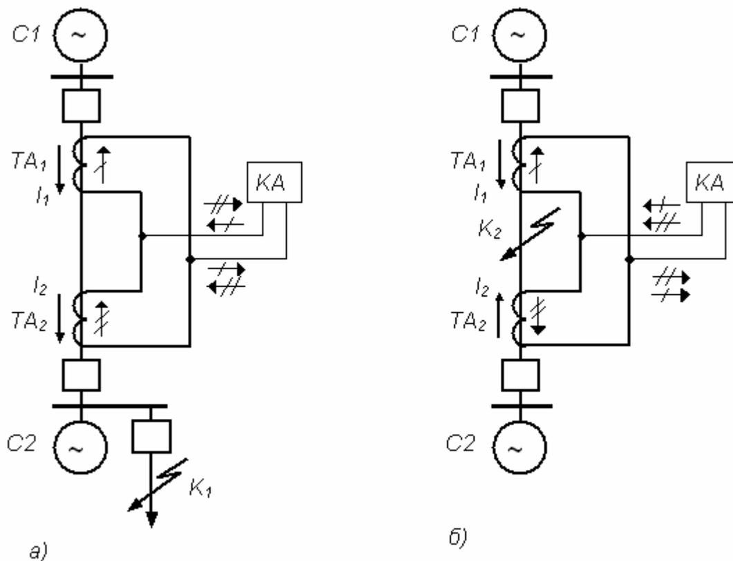
**Рис.66** Схема продольной дифференциальной защиты:
