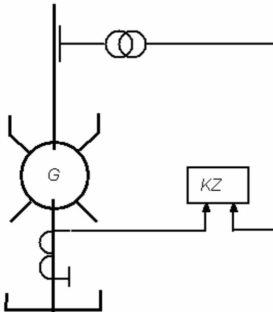
**Рис.98** Схема включения дистанционной защиты от внешних коротких замыканий
