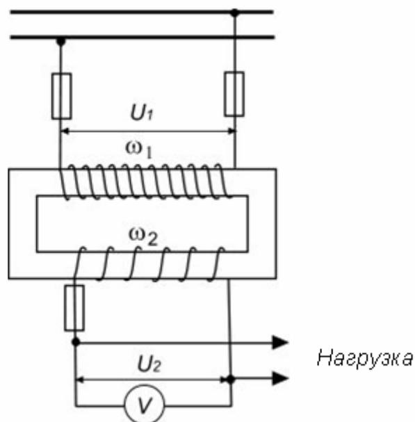
Рис.12 Устройство трансформатора напряжения
