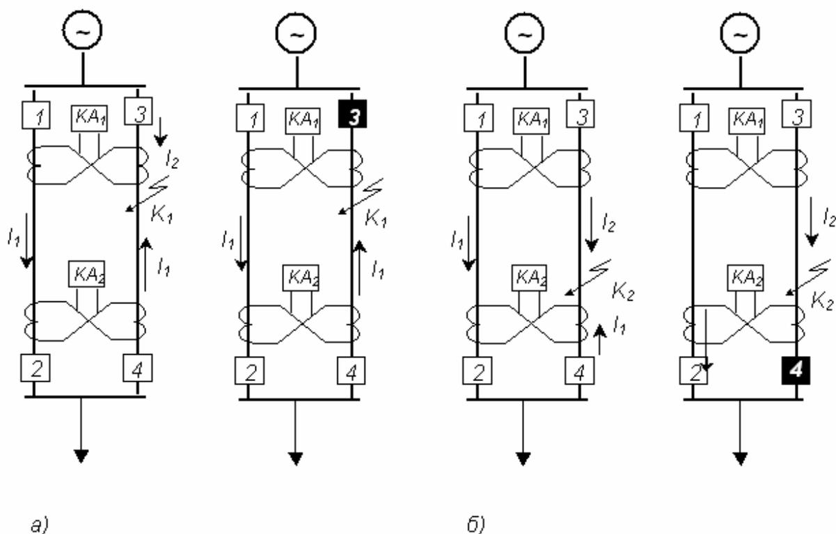
**Рис.69** Каскадная работа поперечной дифференциальной защиты:
