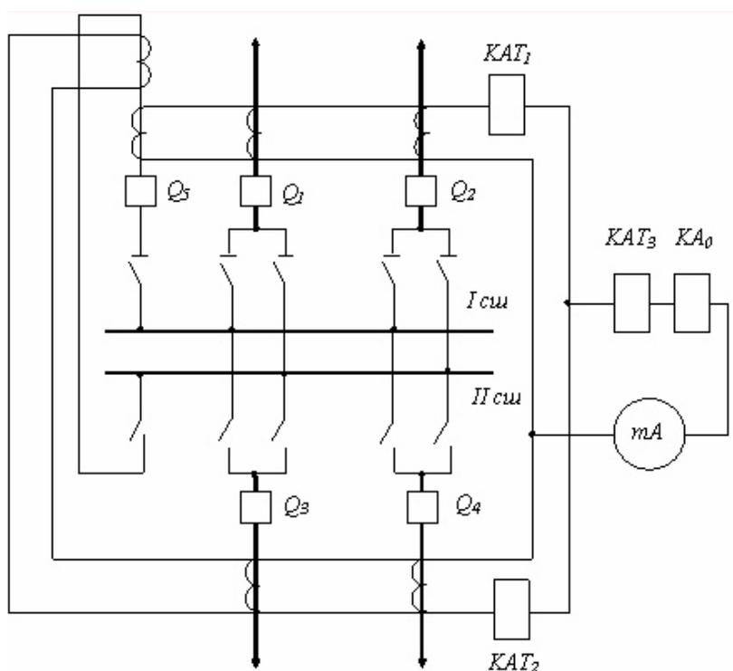
**Рис.106** Схема дифференциальной защиты для подстанции с фиксированным включением присоединений
