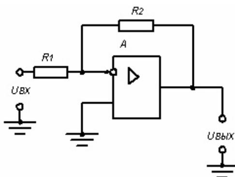
Рис.22 Инвертирующий усилитель
