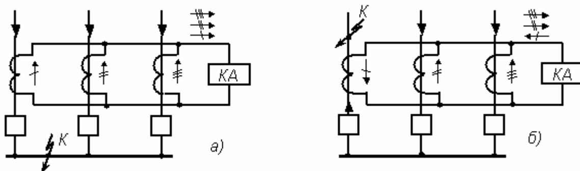
**Рис.104** Принцип действия дифференциальной защиты шин
