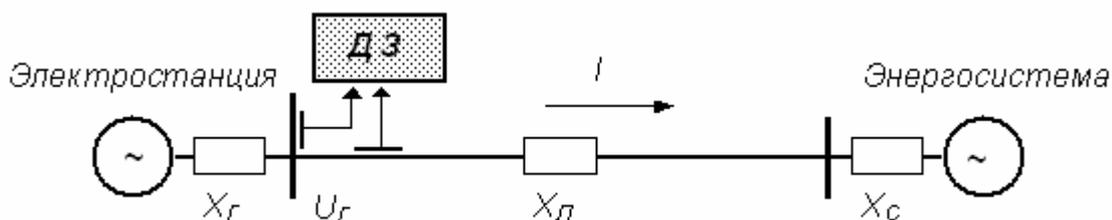
**Рис.63** Схема работы электростанции на приемную энергосистему:  $U_G$  - напряжение на шинах электростанции;  $I$  - ток в линии;  $X_G$  - сопротивление генераторов электростанции;  $X_L$  - сопротивление линии связи;  $X_C$  - сопротивление системы.
