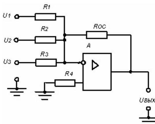
Рис.25 Схема сумматора
