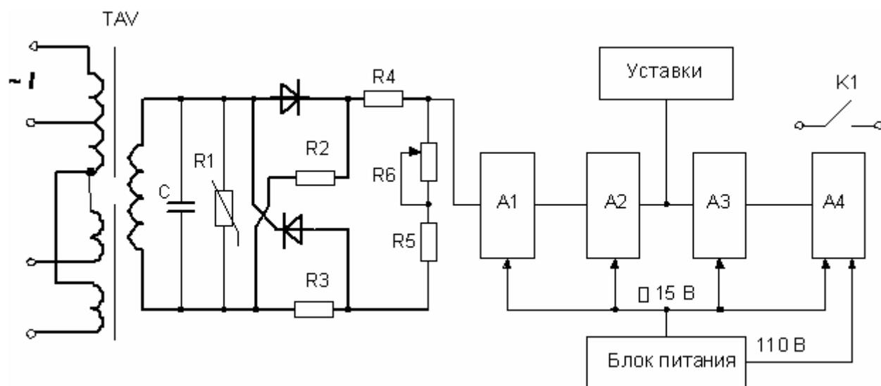
Рис. 78 Дифференциальное реле тока типа PCT 15
