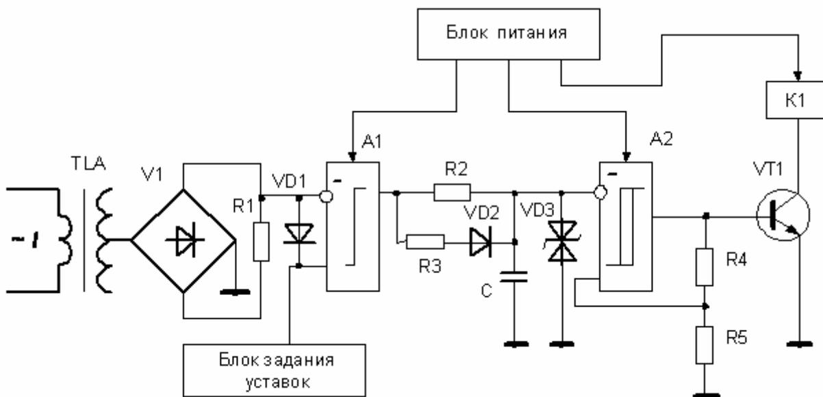
Рис.32 Структурная схема реле тока типа РСТ 13
