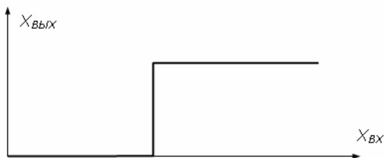
**Рис.17** Релейная характеристика срабатывания:
