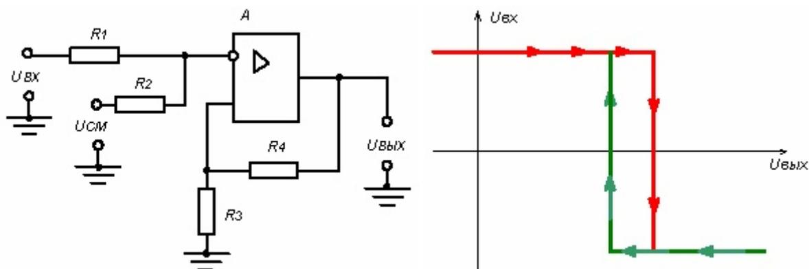
Рис.29 Триггер Шмитта и его передаточная характеристика
