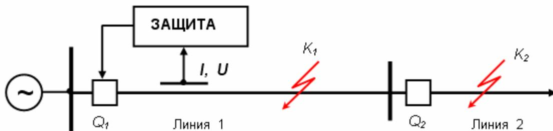
Рис. 6 Схема защиты одиночной линии
