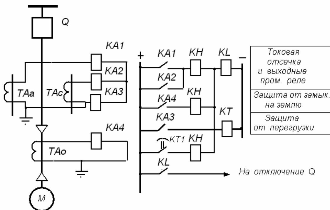
Рис.102 Схема защиты асинхронного электродвигателя мощностью до **4000 кВА**
