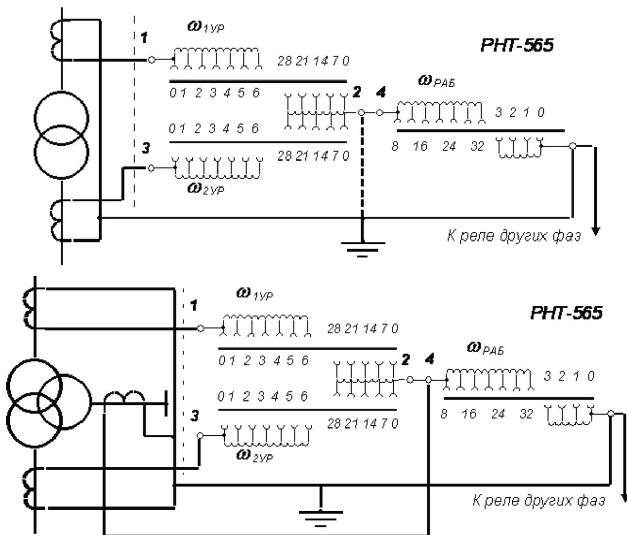
Рис.77 Примеры схем включения реле типа РНТ 565
