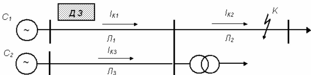
Рис.65 К расчету параметров срабатывания дистанционной защиты
