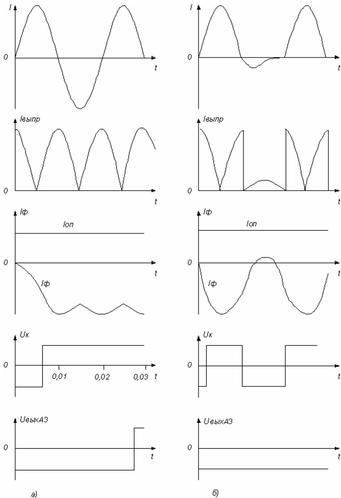
**Рис.80** Временные диаграммы работы реле:
