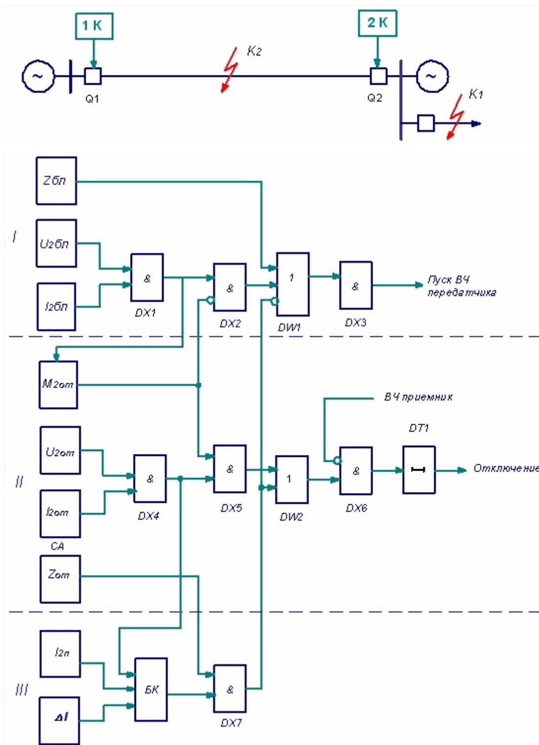
**Рис.71** Упрощенная принципиальная схема логической части РДЭ 2802
