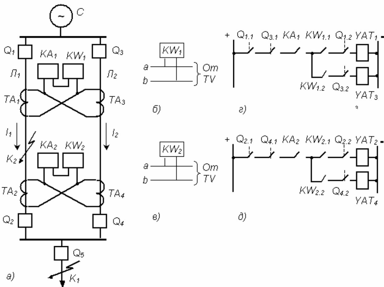
**Рис.68** Поперечная дифференциальная токовая защита параллельных линий:
