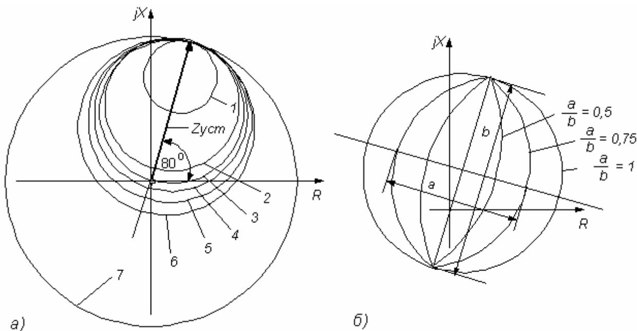
Рис.59 Характеристики срабатывания реле сопротивления блока БРЭ 2801
