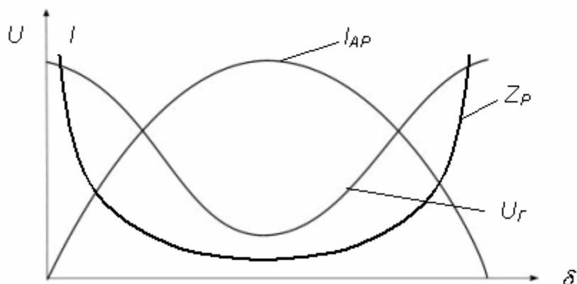
**Рис.64.** Изменение напряжения и тока в процессе асинхронного режима:  $U_G$  - напряжение в месте установки защиты;  $I_{ДР}$  - ток асинхронного режима;  $\alpha$  - угол между э.д.с. генераторов и системы
