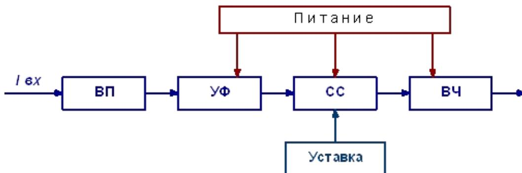
Рис.19 Структурная схема статического реле защиты
