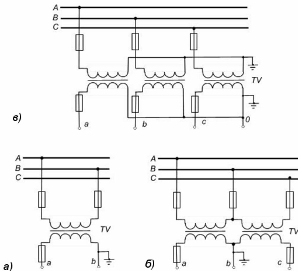
Рис.13 Схемы соединения однофазных трансформаторов напряжения
