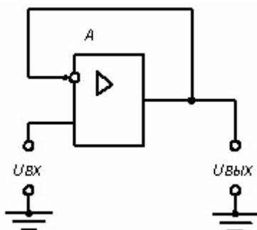
Рис.21 Повторитель напряжения
