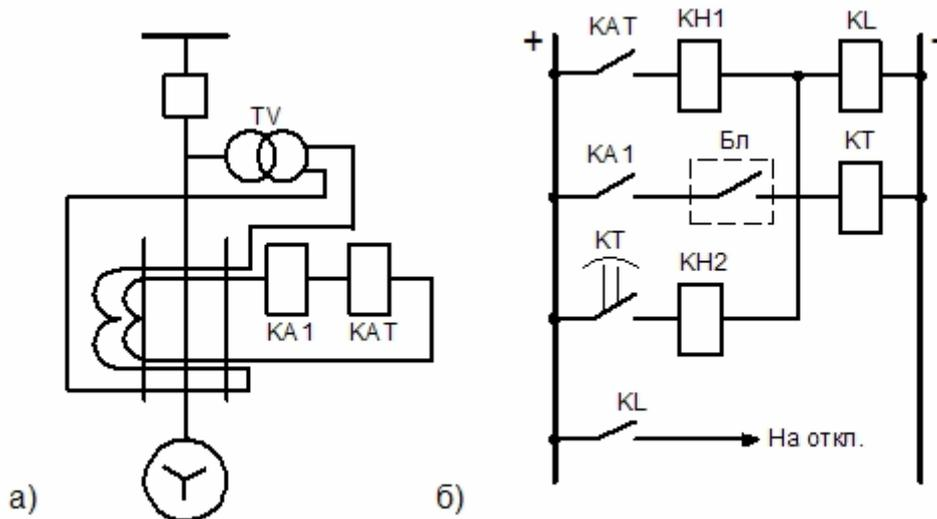
**Рис.92** Схема защиты генератора от замыканий на землю
