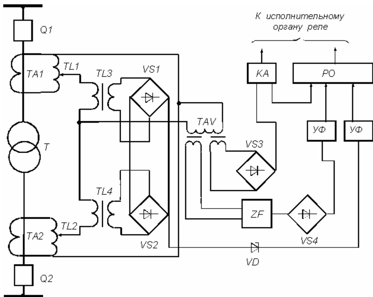
**Рис.81** Однолинейная структурная схема защиты ДЗТ-21
