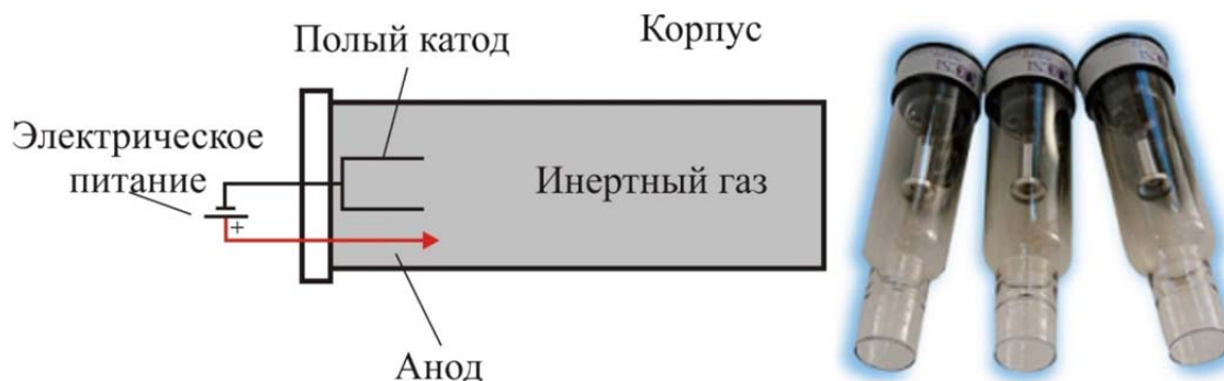
Рис. 5. Лампа с полым катодом для ААС
