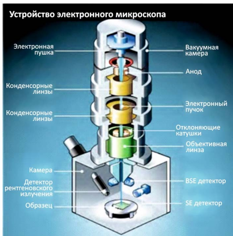
Рис. 38. Принципиальная схема сканирующего электронного микроскопа
