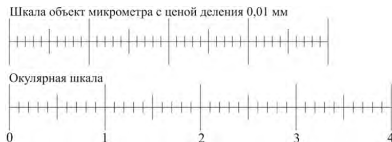
Рис. 7.2. Совмещенные шкалы объект-микрометра и окулярной шкалы
