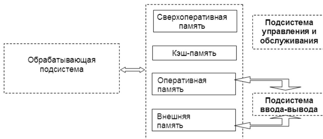
Рис. 4. Обобщенная структура компьютера
