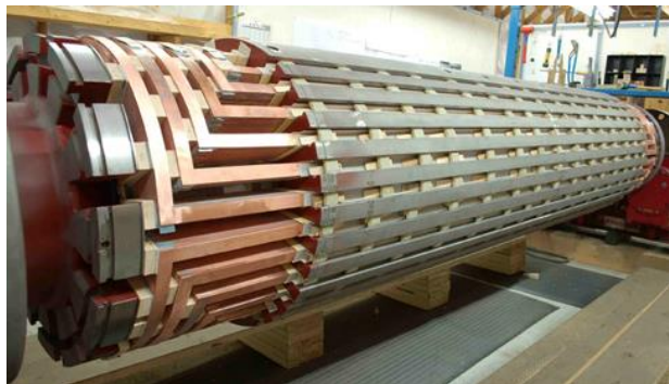
Поперечный разрез ротора, Медные стержни обмотки «насыпаются» в пазы и крепятся немагнитными клиньями
