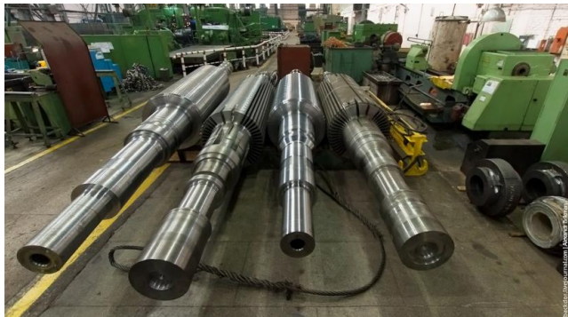
Цельнокованные валы роторов турбогенераторов, рабочая часть до 7 м, полная длина до 12-15 м
