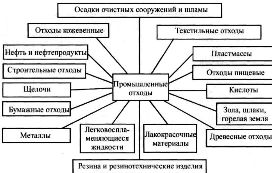
Рис. 1.1. Источники возникновения твердых отходов материальном производстве
