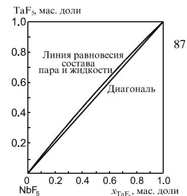
Рис. 4.3. Диаграмма зависимости состава пара от состава жидкости при температуре кипения
