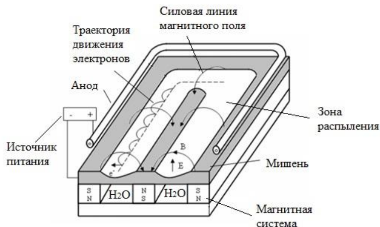
Рисунок 1.1 – Схема магнетронной распылительной системы с плоской мишенью [3]
