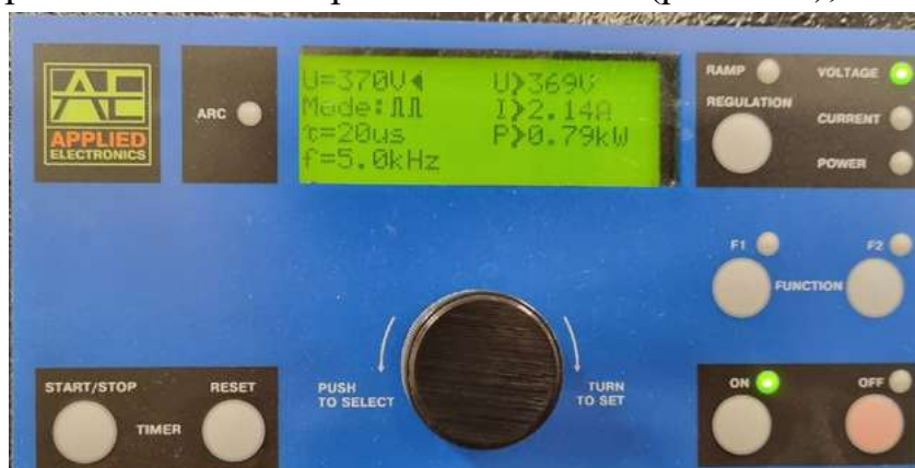
Рисунок 1.12 – Панель управления сильноточным блоком питания магнетронной распылительной системы.
