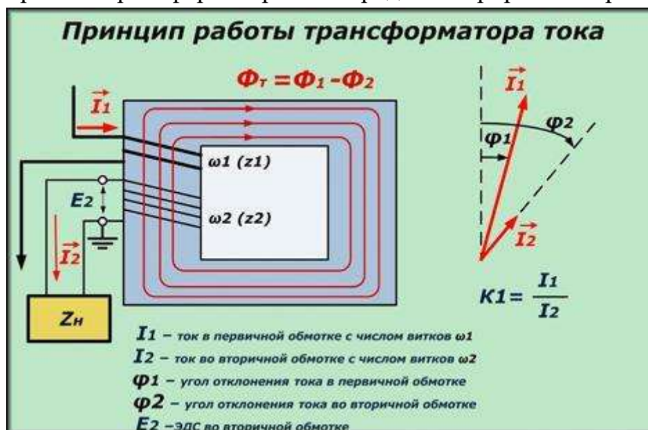
Рисунок 1.6 – Принцип работы ИТТ.
