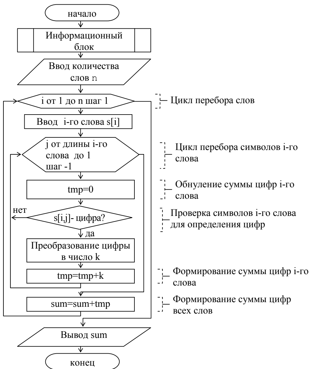
Рис. 7.1. Блок-схема алгоритма определения суммы цифр, содержащихся в массиве слов
