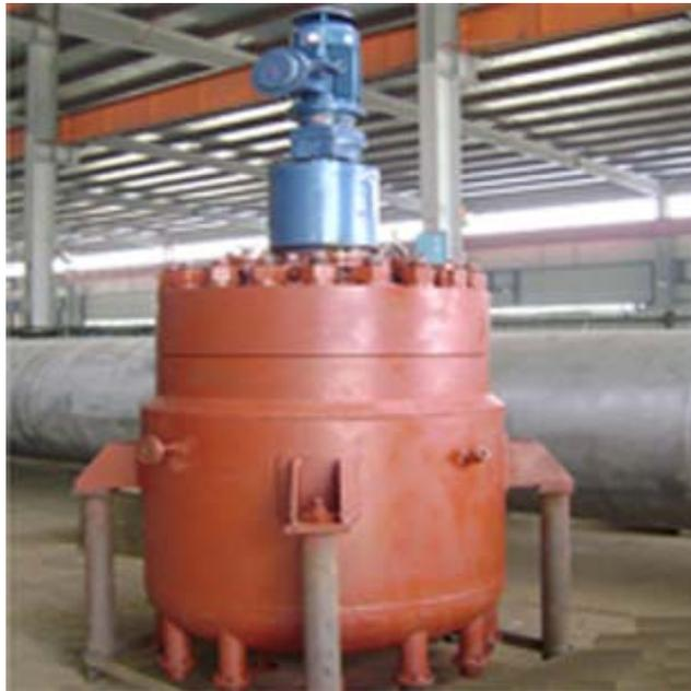
Рис. 2.11,а. Реактор с мешалкой
