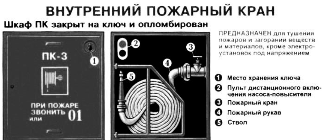
Рис. 2.3. Внутренний пожарный кран
