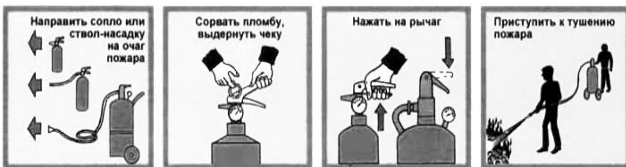
Рис. 2.12. Приведение в действие порошкового огнетушителя закачного
