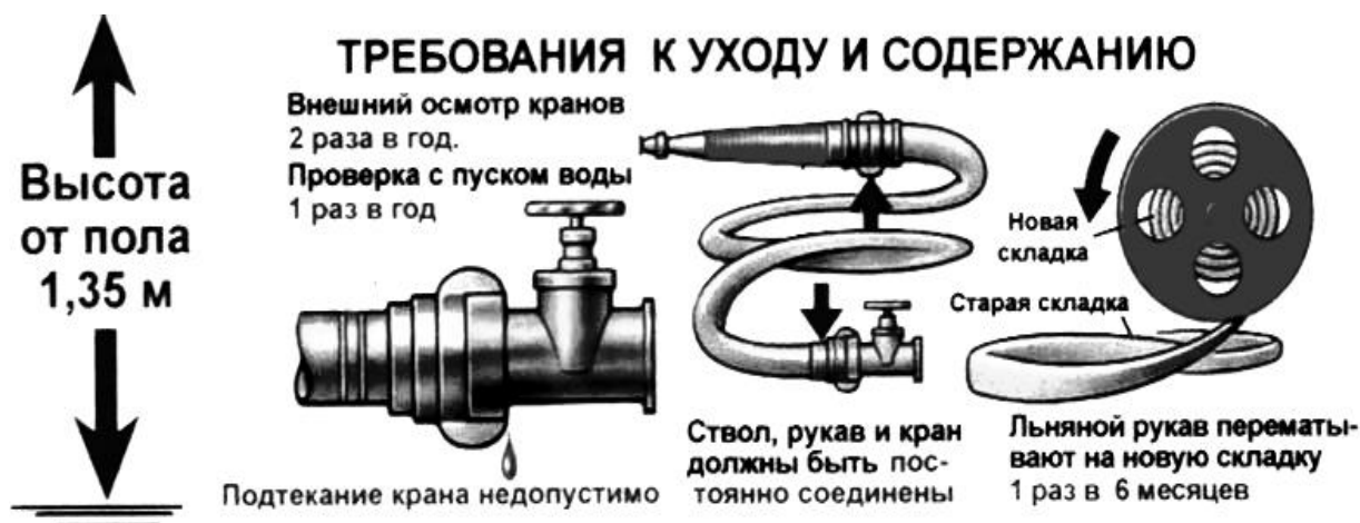
Рис. 2.4. Требования к уходу и содержанию пожарных кранов
