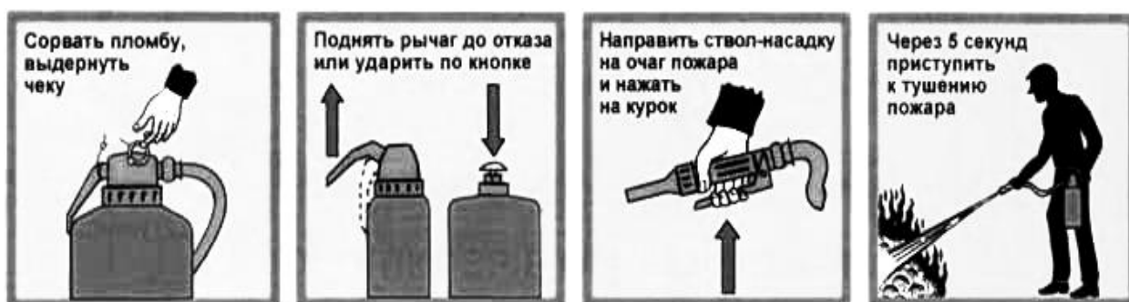
Рис. 13. Приведение в действие порошкового огнетушителя со встроенным источником давления
