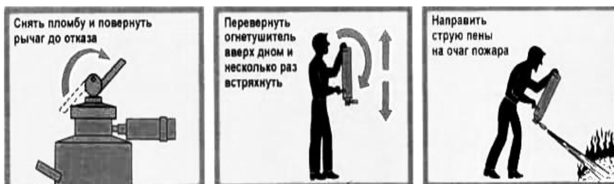
Рис. 15. Приведение в действие химического пенного огнетушителя
