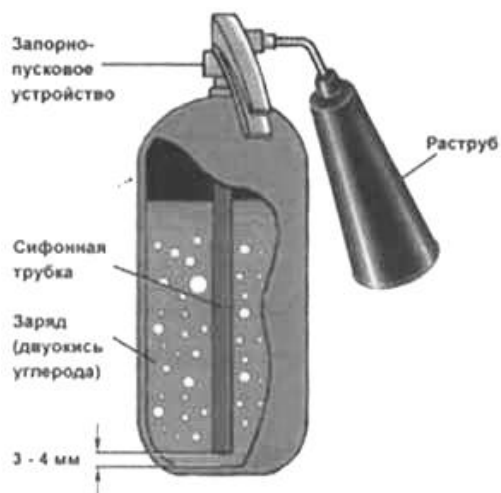
Рис. 6. Конструкция углекислотного огнетушителя
