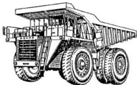
Рис. 6.11. Автосамосвал БелАЗ-75211 грузоподъемно- стью 180 т
