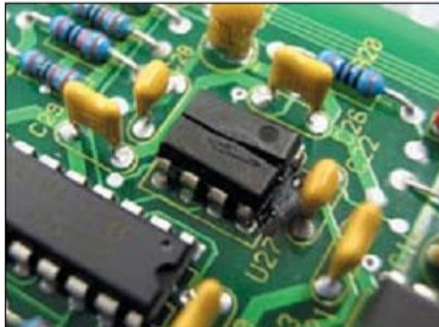
Рис.11 Поврежденная интегральная схема после электрической перегрузки
