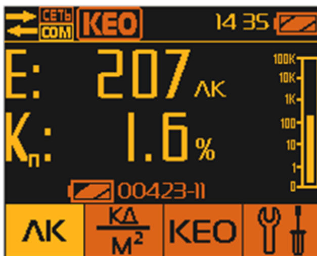
Рис.6 Измерение освещенности с помощью внутренней фотоголовки
