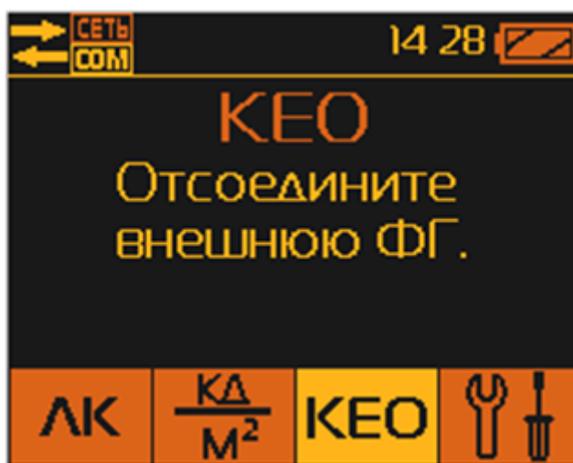
Рис. 3 Отсоединение внешней фотоголовки
