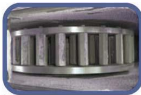
Рабочие органы измельчителя-дизинтегратора ГОРИЗОНТ 3000МК после ресурсных испытаний (помол портландцемента М500 Д0, 75 моточасов, около 340 000 кг)
