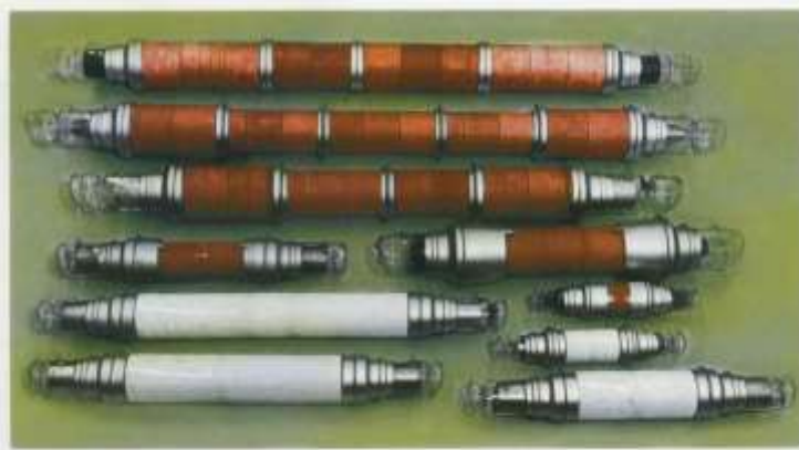
III. Внешний вид ЛЭ «Кузнец» и «Кристалл»: LT-50Cu, LT-40Cu, LT-30Cu (справа вверх); LT-10Cu, LT-20Cu (справа вниз в левом ряду); LT-9Cu, LT-5Cu, LT-1Cu, LT-6Cu (справа вверх и правом ряду)
