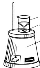
Рис. П.33. Мешалка магнитная, 1 – стакан с жидкостью, 2 – железный стержень в пластмассовой оболочке, 3 – корпус мешалки
