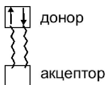
Рис. 4.9. Схема образование химической связи по донорно-акцепторному механизму
