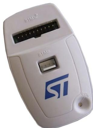
Рис. 1.2. Программатор *ST-LINK/V2*
