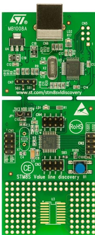
Рис. 1.1. Отладочная плата *STM8SVLDISCOVERY*
