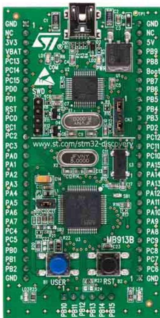
Рис. 1.4. Отладочная плата *STM32VLDISCOVERY*
