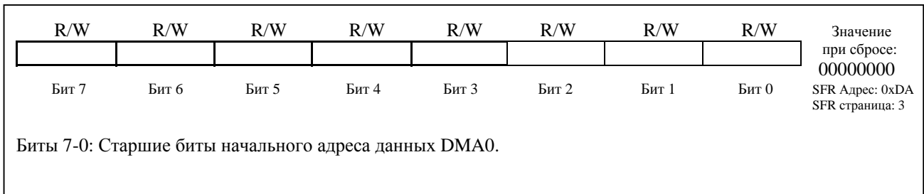
Рисунок 6.10. DMA0DAH: Регистр старшего байта начального адреса данных DMA0.
