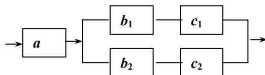
Найти надежность системы – вероятность того, что система будет исправна в течение некоторого времени, если известны надежности блоков  $P(a) = 0,95$ ;  $P(b_k) = 0,9$ ;  $P(c_k) = 0,8$ .
