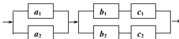
Найти надежность системы – вероятность того, что система будет исправна в течение некоторого времени, если известны надежности блоков  $P(a_k) = 0,85$ ;  $P(b_k) = 0,9$ ;  $P(c_k) = 0,95$ .
