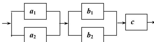
Найти надежность системы – вероятность того, что система будет исправна в течение некоторого времени, если известны надежности блоков  $P(a_k) = 0,8$ ;  $P(b_k) = 0,9$ ;  $P(c) = 0,85$ .
