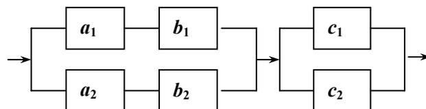
Найти надежность системы – вероятность того, что система будет исправна в течение некоторого времени, если известны надежности блоков  $P(a_k) = 0,7$ ;  $P(b_k) = 0,9$ ;  $P(c_k) = 0,8$ .
