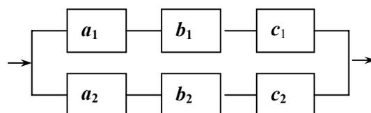
Найти надежность системы – вероятность того, что система будет исправна в течение некоторого времени, если известны надежности блоков  $P(a_k) = 0,9$ ;  $P(b_k) = 0,9$ ;  $P(c_k) = 0,8$ .
