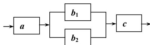
Найти надежность системы – вероятность того, что система будет исправна в течение некоторого времени, если известны надежности блоков  $P(a) = 0,95$ ;  $P(b_k) = 0,9$ ;  $P(c) = 0,99$ .
