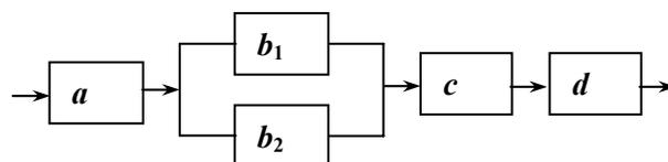
Найти надежность системы – вероятность того, что система будет исправна в течение некоторого времени, если известны надежности блоков  $P(a) = 0,95$ ;  $P(b_k) = 0,9$ ;  $P(c) = 0,8$ ;  $P(d) = 0,85$ .
