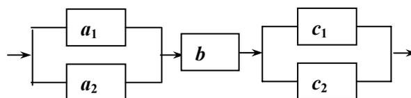
Найти надежность системы – вероятность того, что система будет исправна в течение некоторого времени, если известны надежности блоков  $P(a_k) = 0,8$ ;  $P(b) = 0,95$ ;  $P(c_k) = 0,85$ .
