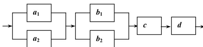
Найти надежность системы – вероятность того, что система будет исправна в течение некоторого времени, если известны надежности блоков  $P(a_k) = 0,8$ ;  $P(b_k) = 0,9$ ;  $P(c) = 0,99$ ;  $P(d) = 0,95$ .
