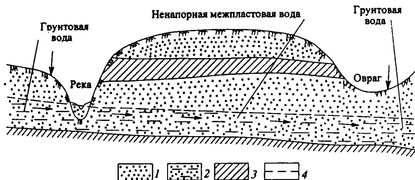
Рис. 3.9. Схема залегания потока межпластовых ненапорных вод: 1 — песок; 2 — песок водоносный; 3 — глина; 4 — уровень межпластовых вод
