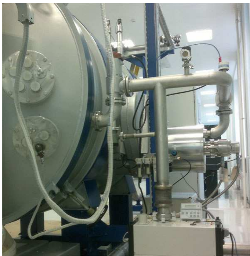
Рис. 14.1. Стенд-тренажер для исследования ручной сварки в условиях, имитирующих космические
