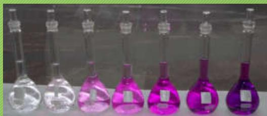
Концентрацию органических примесей более точно определяют добавлением сильных окислителей. Расход окислителя, необходимого для окисления органических примесей, содержащихся в 1 л воды называют **окисляемостью**.
