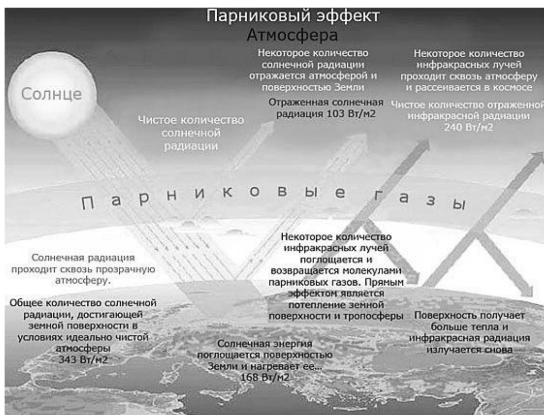
Рисунок 16. Поглощение и переизлучение Землей солнечной энергии. “Парниковый эффект” атмосферы (цифры означают долю в % того или иного процесса в энергетическом балансе Земли)
