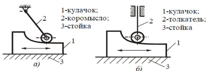
Рис.2.12. Структурные схемы кулачковых механизмов с поступательно движущимся кулачком
