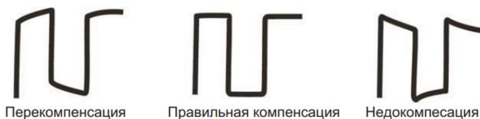
Рис.9. Варианты осциллограмм при настройке компенсации пробника
