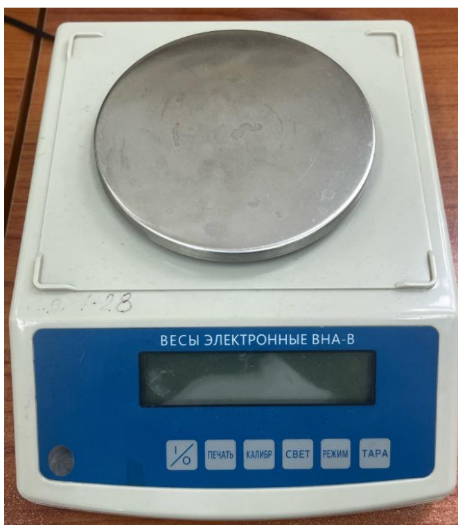
Рисунок 5 – Внешний вид аналитических весов ВНА-В-600
