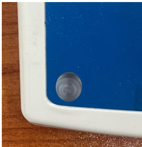
Рисунок 6 – Вид встроенного уровня при горизонтальном положении весов
