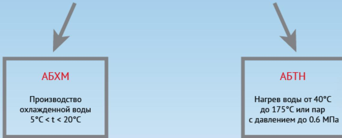
**Утилизация тепла** посредством абсорбционных холодильных технологий осуществляется двумя способами: посредством абсорбционных бромисто-литиевых холодильных машин (АБХМ) или абсорбционных бромисто-литиевых тепловых насосов (АБТН). При этом осуществляется один и тот же термодинамический цикл, но в разных температурных диапазонах.
