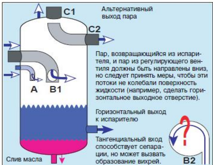
Рис. 08. Вертикальный отделитель жидкости
