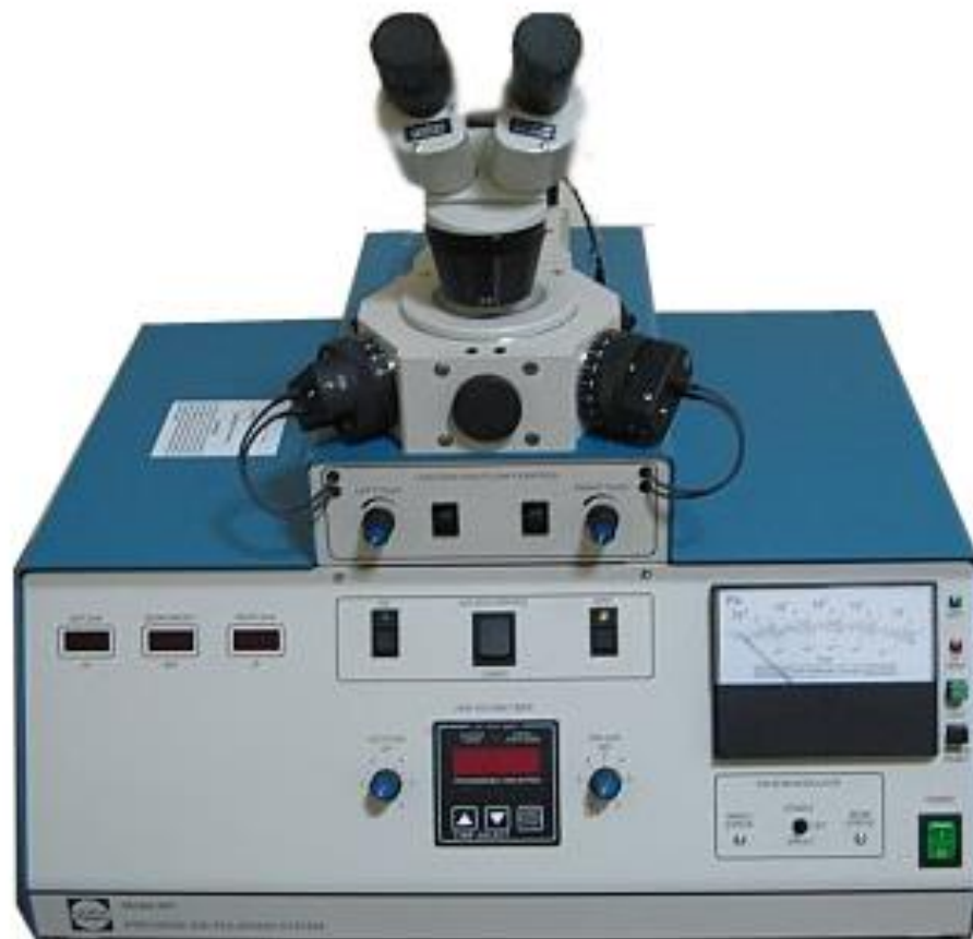
Установка ионного утонения ТЭМ-образцов Gatan PIPS
