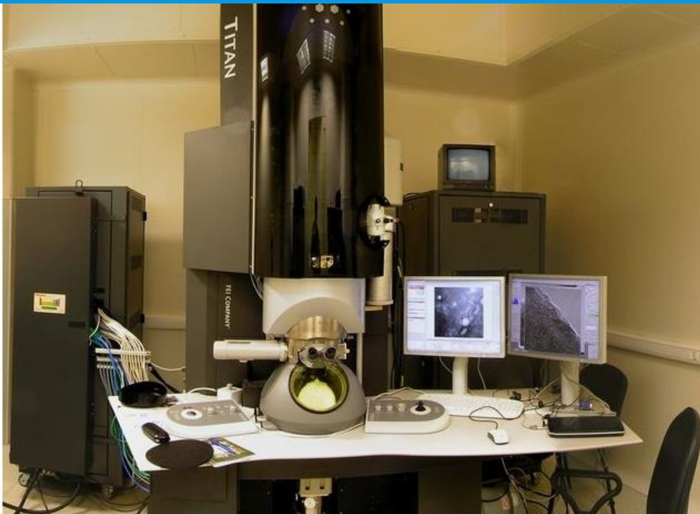
Просвечивающий электронный микроскоп FEI Titan с ускоряющим напряжением 80-300кВ
