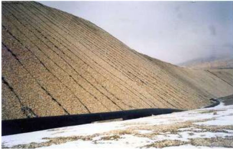
Кучное выщелачивание золота из руды с содержанием 0,7 г/т
