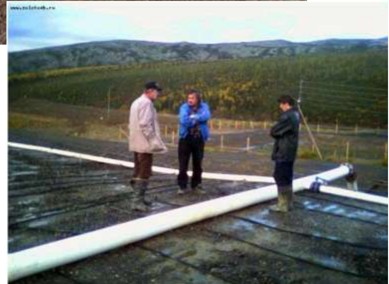
Капельная система орошения на поверхности рудного штабеля
