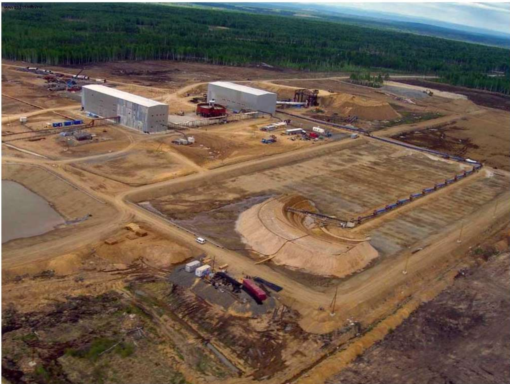
Месторождение «Пионер» в Амурской области обрабатывается по комплексной технологии «золотоизвлекательная фабрика-кучное выщелачивание»
