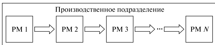
Рис. 25. Линейная (поточная) планировка
