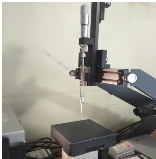
Рисунок 2.6 – Крепление шприца и подъемный столик
