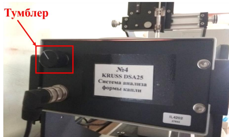
Рисунок 2.5 – Включение угломера Drop Shape Analysis System – DSA25
