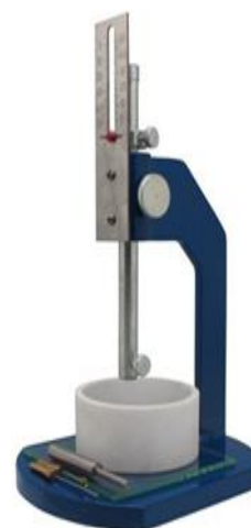
Рис.3. Прибор Вика (а) для определения нормальной плотности и сроков схватывания цементного теста и приспособления к нему (б-г):
