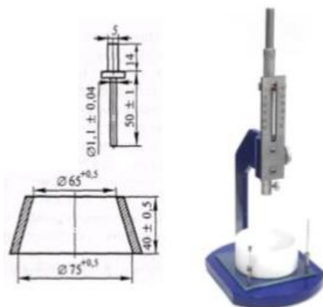
Рис.6. Прибор Вика для определения сроков схватывания гипсового вяжущего
