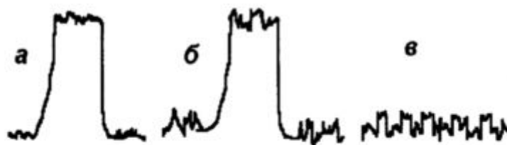
Рис. 22. Атомно-абсорбционный сигнал: а – хорошее соотношение сигнал / шум; б – плохое соотношение сигнал / шум; в – сигнал и фон на пределе обнаружения
