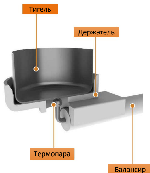
Рисунок 7 Механизм регистрации веса и температуры тигля
