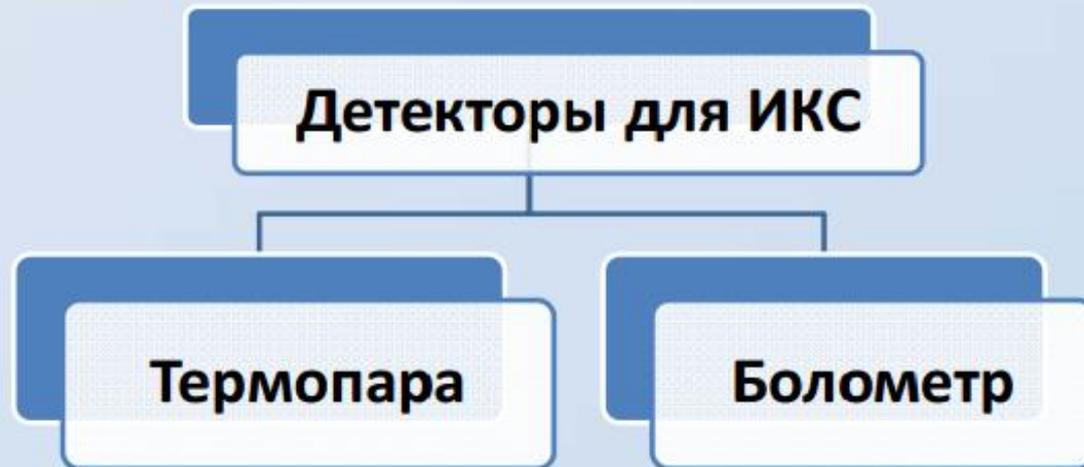
**Термопара** (термоэлемент) преобразует энергию ИК-излучения в тепловую, а затем электрическую. Разность потенциалов регистрируют обычным способом.
