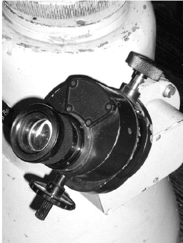
Рис. 5. Отсчетный измерительный микроскоп (в составе кольцевого сферометра)
