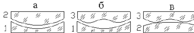
Рис. 4. Абсолютный метод измерения трех плоских пробных стекол
