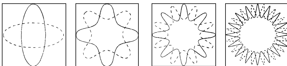
Рис. 40. Моды стоячих волн на одной и той же струне
